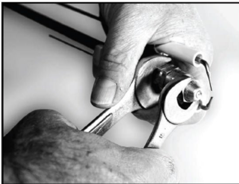
Figure 3A : SOUTENIR SOIGNEUSEMENT L'ADAPTATEUR DE BUSE LORS DU RETRAIT OU DE L'INSTALLATION DE LA BUSE
